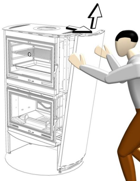
Figura nº21 - Movimiento para la retirada de los costados
